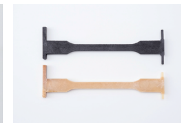
▲ ダンベル試験片 JIS K7139 A1 t4
