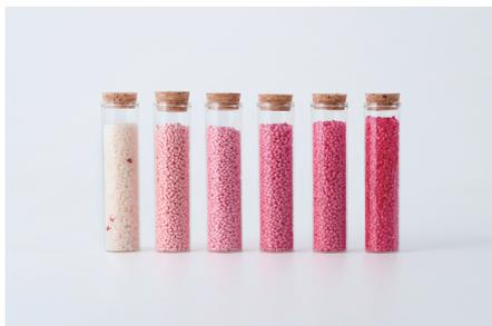
色付きのペレットは一般的に、顔料とペレットを大型の混練機で混ぜることで行われています。しかし、この方法では色合いの調整のために大量のペレットが生産されてしまい、少量の材料で十分な試作シーンでは不向きです。
