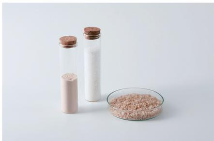
▲ 左の試験管：ヒノキ粉 右の試験管：PEペレット
