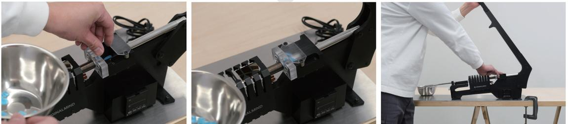
切ったペットボトルキャップを投入口のカバーを開けて投入します。ハンドルの上げ下げを繰り返し、シリンダーの中に切ったペットボトルキャップ押し込みながら、少量づつ入れてください。ハンドルを下げる際は、ペットボトルキャップの破片が飛び出す可能性があるため、投入口のカバーを閉めてください。
