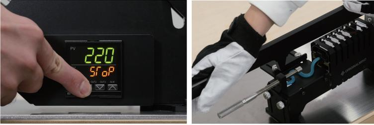
ヒーターを加熱状態のまま放置すると危険です。成形中30分以上成形しない場合はハンドルを下げ、[R/S]ボタンを長押しして加熱をストップしてください。
