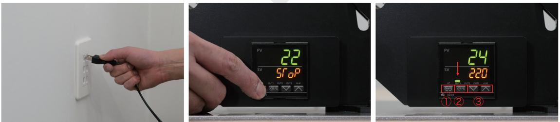
INARI本体をコンセントに接続し、シリンダー目標温度を設定、加熱します。ペットボトルキャップの場合は220℃で溶かすことができます。上の緑色の数字(PV)が現在のシリンダーの温度、下の赤色の数字(SV)が目標温度です。STOPという表示であれば加熱は行われていません。↓のランプがついているときは加熱中です。
