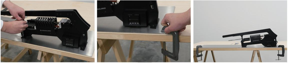
INARI本体をプレートにねじで固定し、プレートと机をクランプで固定します。
