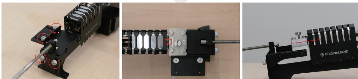
型の位置合わせをします。位置合わせガイドのつまみを緩めて、型の注入口とシリンダーの射出口が合うよう、調整します。
