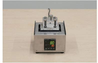
**冷却器**：テーブルに型を載せ、冷やす道具です。電源ケーブルを接続し、ファンを回して使用します。型を連続で使用すると熱がこもり、寸法にも影響が生じます。型を冷やすことで正確な寸法を保ちながら、連続して成形を行うことができます。また、やけどの危険も減らします。
