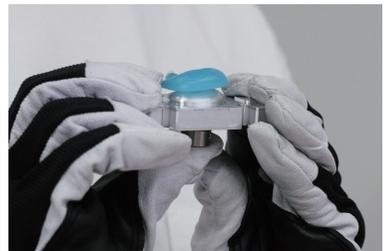
型のねじを外して、成形品を取り外します。型についているピンを押し込むと、簡単に外すことができます。
