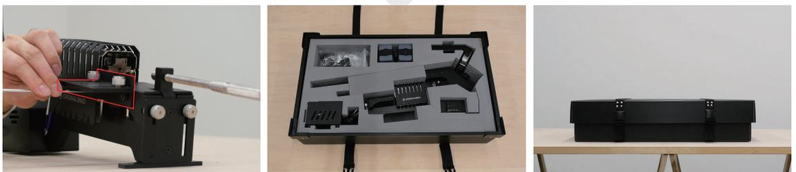
十分にシリンダーの熱が冷めたことを確認して、梱包されていたパッケージに戻してください。戻す際は、位置合わせガイド(赤枠)を取り外してください。ふたが開かないよう、ベルトをしっかりと締めてください。
