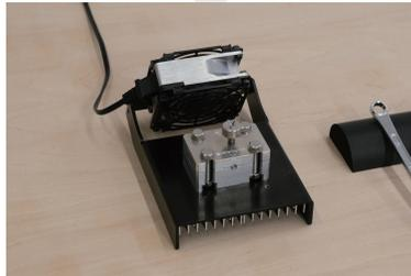
INARIから型を外します。型が熱い場合は冷却器に置いて型を冷やします。
