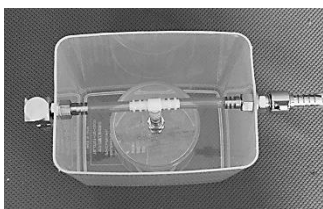
写真 4 初期の調圧器
