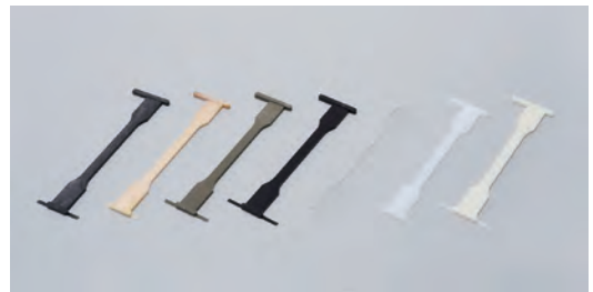
▲ 成形サンプル：ダンベル試験片 JIS K7139 A1 t4
